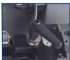
1 System odwracalny z podwójną szczęką, o dwóch pozycjach: a) powielanie kluczy profilowanych b) powielanie kluczy frontowych
