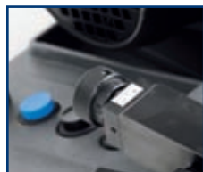
2 Índice copiator con regulación micrométrica.
